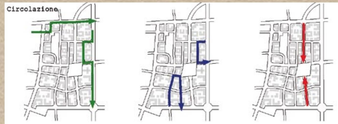
La riorganizzazione della circolazione interna di una ZTM consente di riportare sulla viabilità perimetrale alla zona chi ne tenti l'attraversamento. Attraverso l'interruzione del passaggio di veicoli in determinati incroci si produce un obbligato ritorno sulla viabilità perimetrale (loop).
